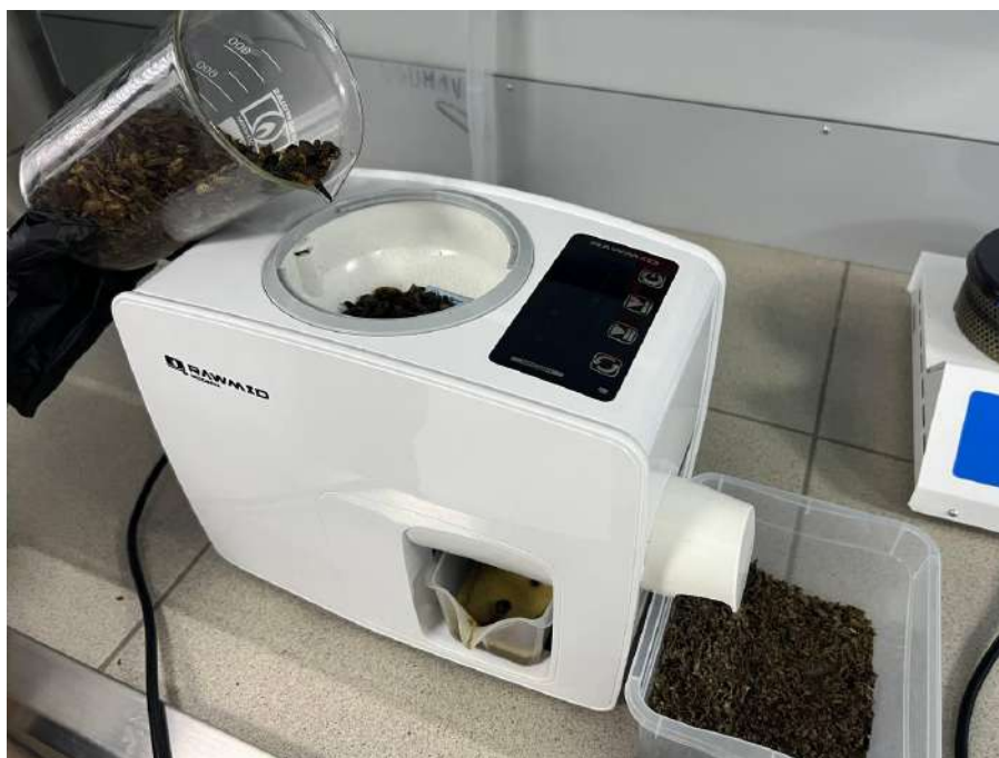
Рисунок 7 – Разделение сушеной биомассы личинок на белковый концентрат и жир при помощи маслопресса
