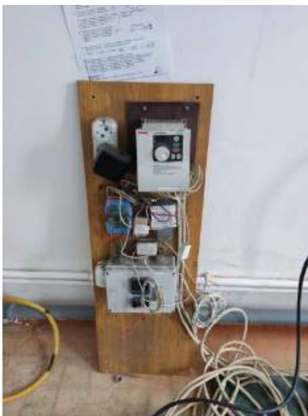
Рисунок 4 – Фото стенда с частотным преобразователем - изготовлена соединительная муфта, соединяющая вал электродвигателя и эксцентриковый вал виброреактора. Муфта состоит из дюритового шланга и двух втулок с отверстиями со шпоночными пазами и антифрикционной насечкой снаружи. Для изготовления муфт были разработаны эскизы (Рисунок 5) в электронном виде и переданы подрядчику для электроэрозионной резки.
