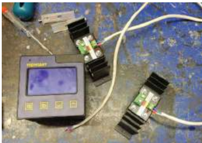
Рисунок 10 – Внешний вид контроллера «Термодат» и силовых блоков (2 шт.)
