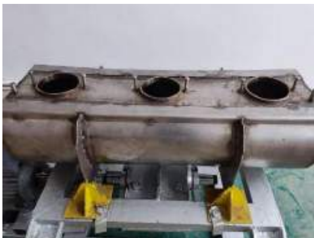
Рисунок 3 – Фото реактора установленного на раму - для управления электродвигателем подобран и установлен частотный преобразователь Mitsubishi FR-S 500E (Рисунок 4):
