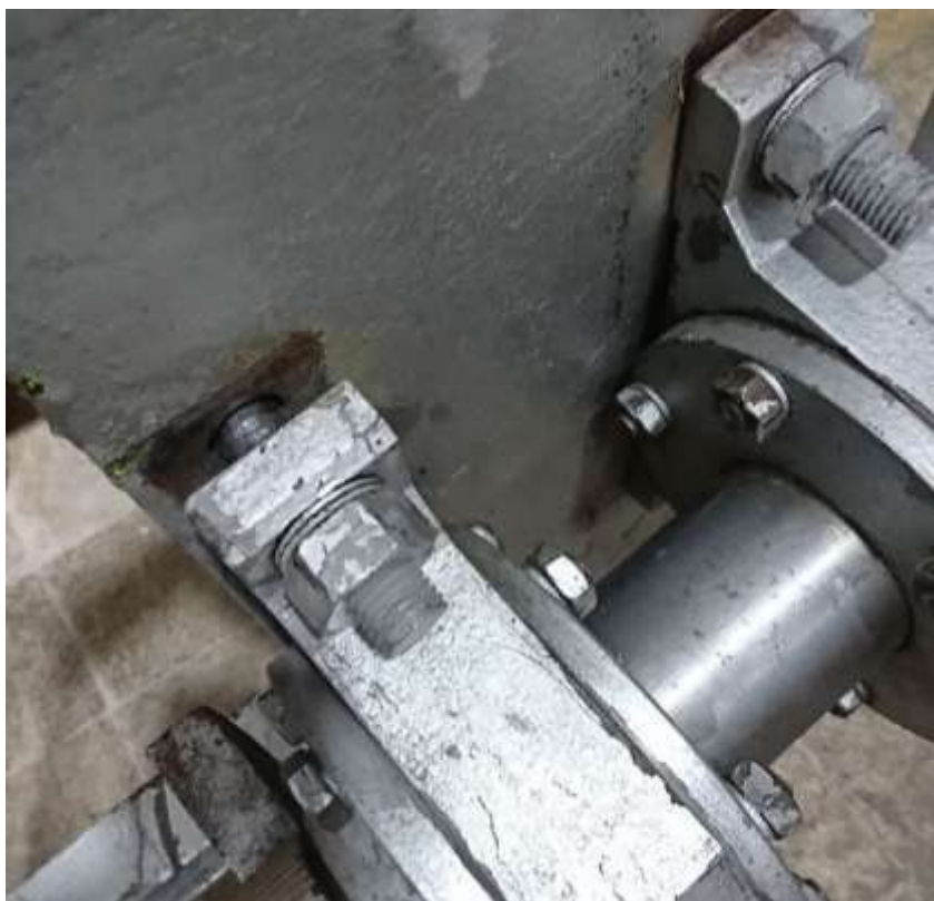
Рисунок 2 – Фотография крепления реактора к вибростенду
