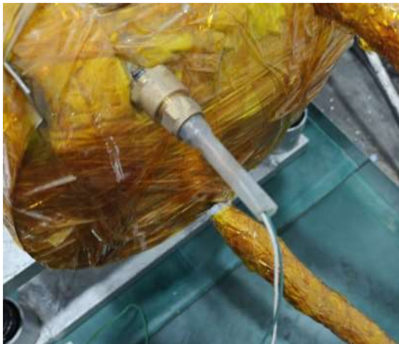
Рисунок 5 – Термопара (ТХА) для детектирования температуры внутри реактора
