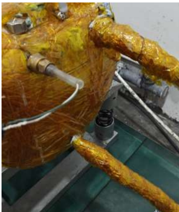
Рисунок 3 – изоляция шлангов для циркуляции теплоносителя
