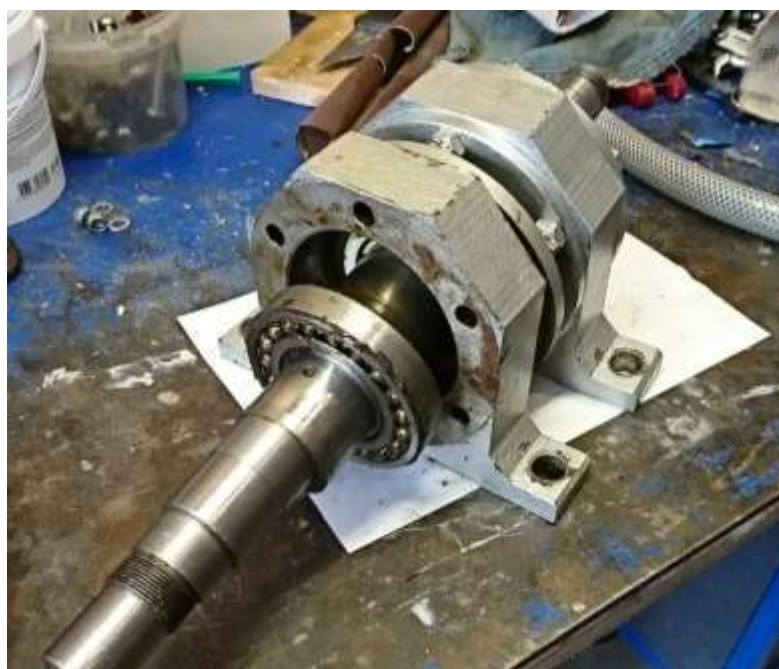
Рисунок 1 – Фотографии: (сверху) вал с подшипниковым узлом на пилотной установке, (в середине) демонтированный (снизу) разобранный подшипниковый узел
