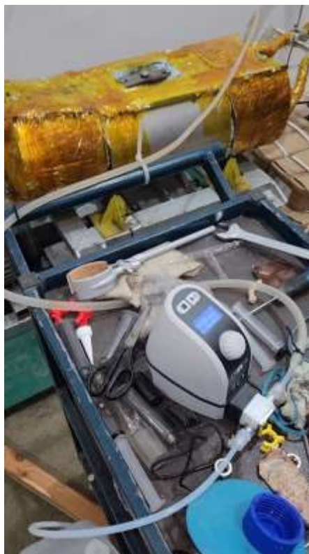
Рисунок 13 – Мембранный насос подачи этанола в реактор
