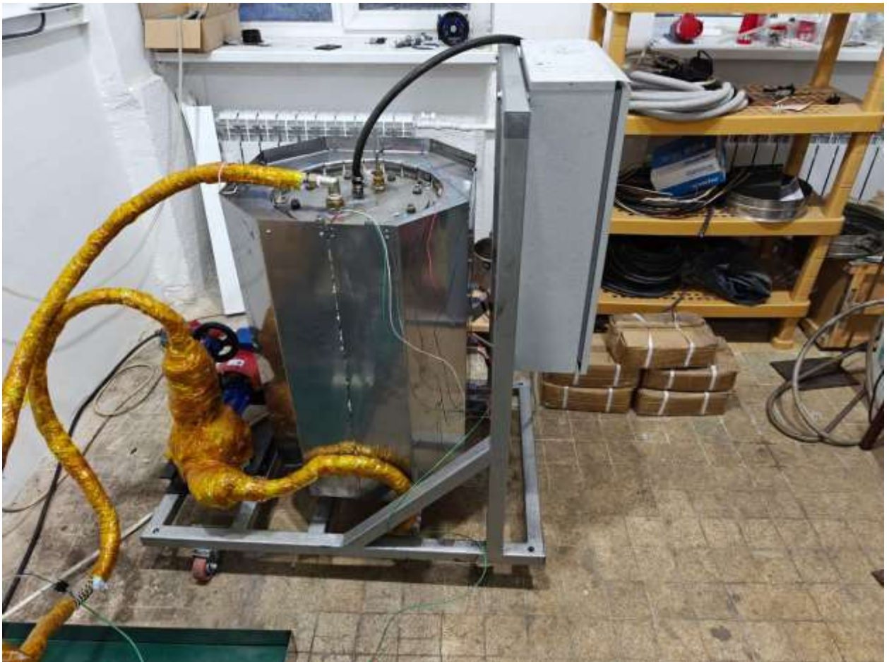
Рисунок 6 – Высокотемпературный термостат в сборе
