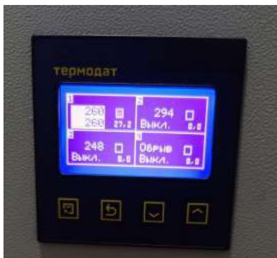
Рисунок 10 – Контроллер «Термодат» для уставки и детектирования температуры теплоносителя и внутри реактора
