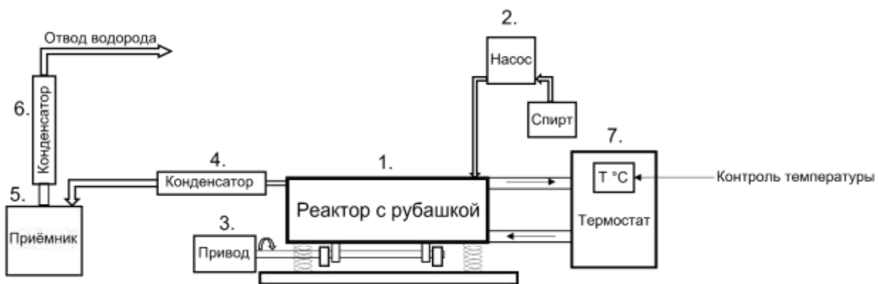
Рисунок 12 – Схема пилотной установки синтеза тетраэтоксисилана
