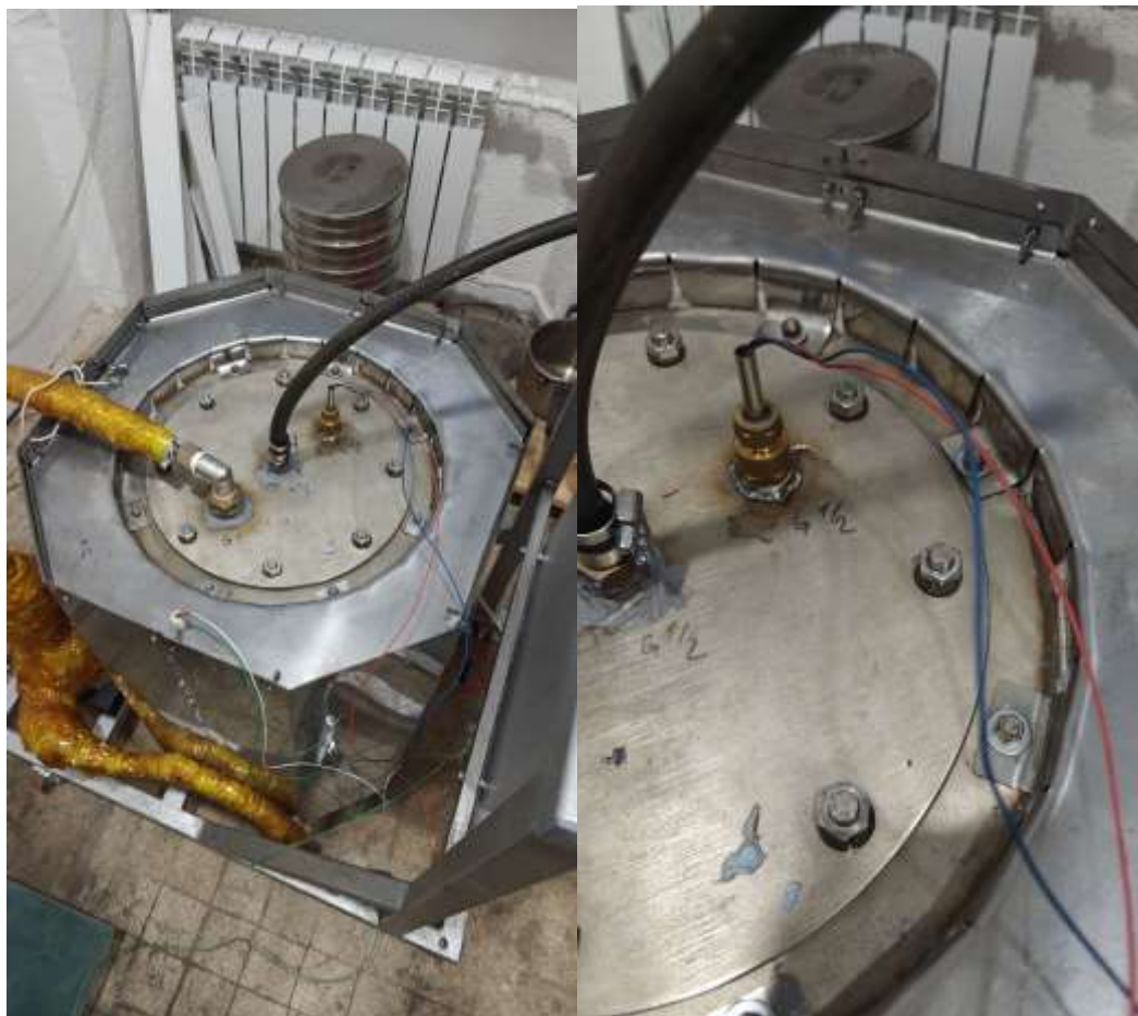
Рисунок 7 – Термопара для контроля температуры теплоносителя в баке теплоносителя
