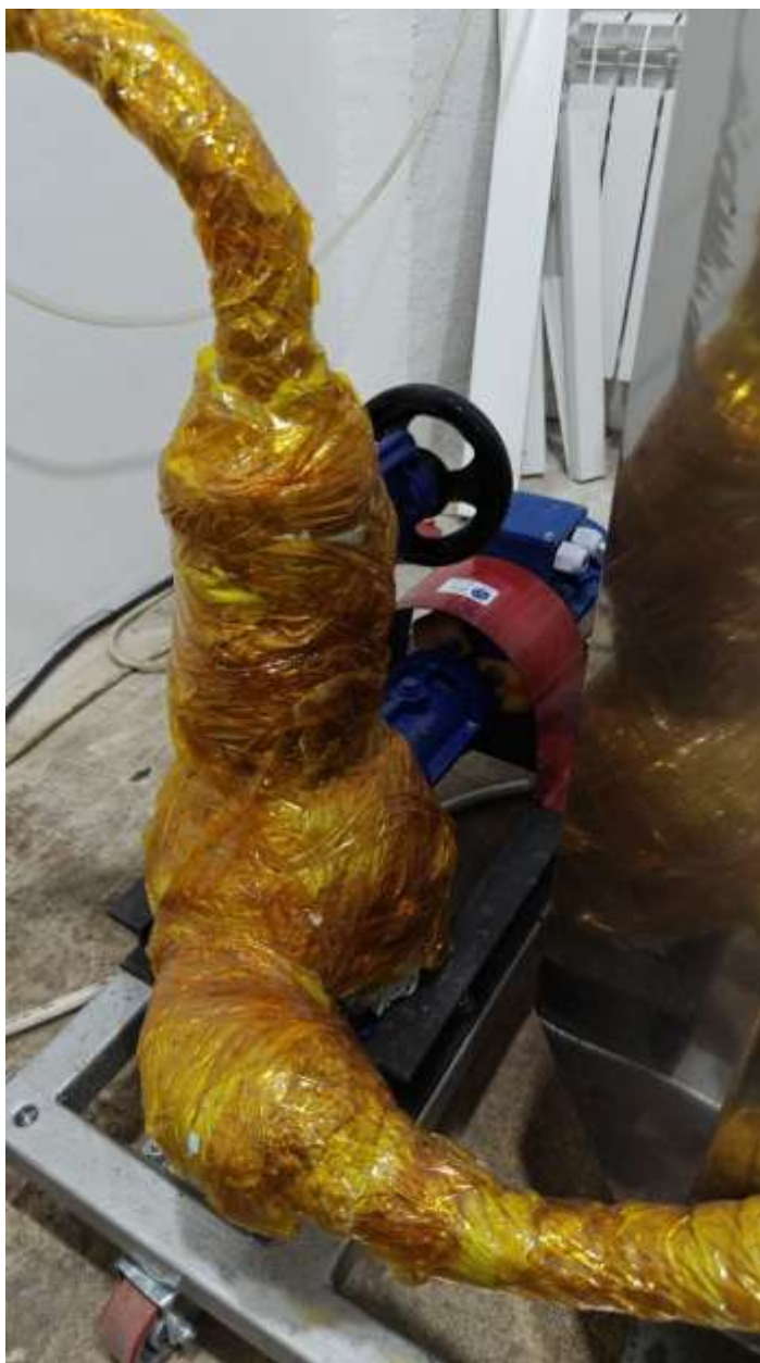
Рисунок 8 – Насос для циркуляции теплоносителя
